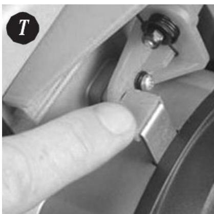
8. Utilice la llave hexagonal de 6 mm proporcionada para aflojar y quitar el perno de la cuchilla. (Afloje en el sentido de las agujas del reloj ya que el tornillo de la cuchilla tiene una rosca a la izquierda) (fig. U).
