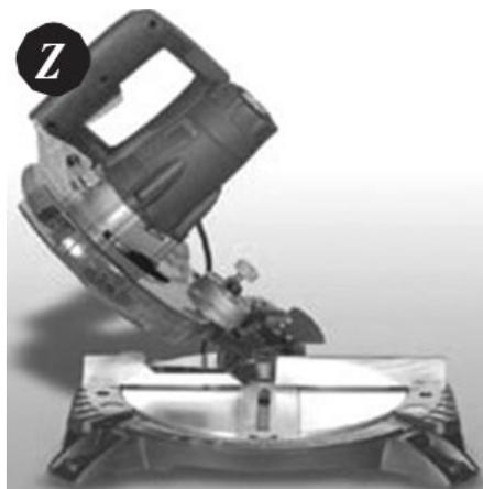
1. Tire del eje (2) y levante el brazo de la sierra hasta su altura máxima.
