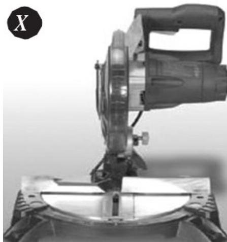
1. Tire del eje (2) y levante el brazo de la sierra (1) a su altura máxima.
