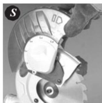
7. Sostenga la protección giratoria (5) hacia arriba y presione el botón de bloqueo del eje (18). Gire la cuchilla hasta que el eje se bloquee (fig. T).
