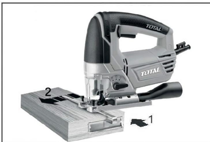
Monte o adaptador de remoção de chip de vácuo
