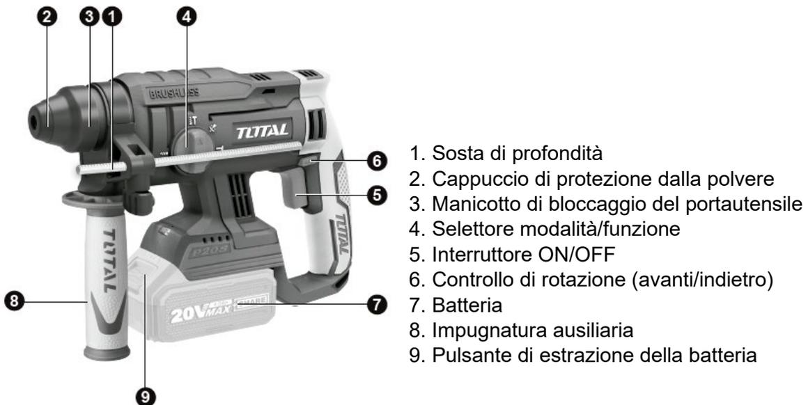
La macchina è progettata per la perforazione e la scalpellatura a percussione di cemento o mattoni. È adatto anche per la foratura senza impatto su legno, metallo, ceramica e plastica.
