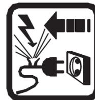
Se o cabo for danificado ou cortado durante o trabalho, não toque no cabo, desconecte imediatamente a ferramenta. Nunca use a máquina com um cabo danificado.
