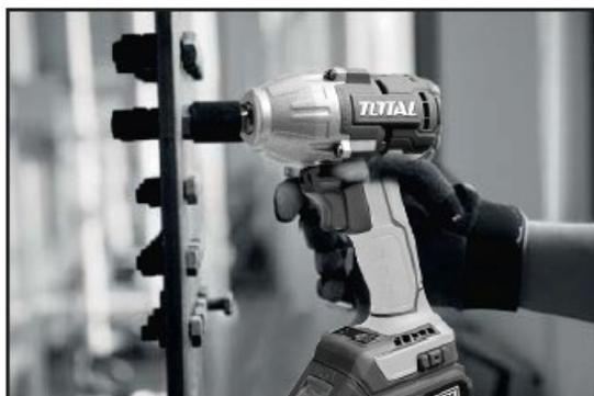
Tenere una mano sull'impugnatura e l'altra sul fondo della cartuccia della batteria per controllare l'azione di torsione.
