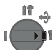
Posición de Vario-Lock para ajustar la posición de cincelado. El interruptor selector de modo (8) no se bloquea en esta posición.
