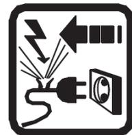
Se o cabo for danificado ou cortado durante o trabalho, não toque no cabo, desligue imediatamente a ferramenta. Nunca use a máquina com um cabo danificado.
