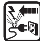
Se o cabo estiver danificado ou cortado durante o trabalho, não toque no cabo, desconecte imediatamente a ferramenta. Nunca use a máquina com um cabo danificado.
