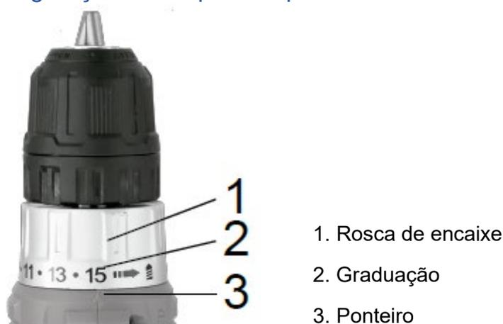
O torque pode ser ajustado em 18 etapas girando o anel de ajuste de forma que suas graduações fiquem alinhadas com o ponteiro no corpo da ferramenta. O torque de aperto é mínimo quando o número 1 está alinhado com o ponteiro e máximo quando a marca
