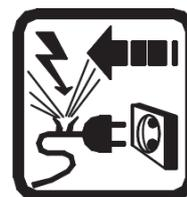
Si el cable está dañado o cortado durante el trabajo, no toque el cable, desconecte inmediatamente la herramienta. Nunca use la máquina con un cable dañado.
