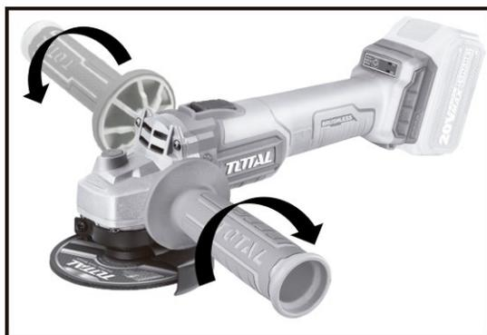
Atornille firmemente la empuñadura lateral en la posición de la herramienta como se muestra en la figura.
