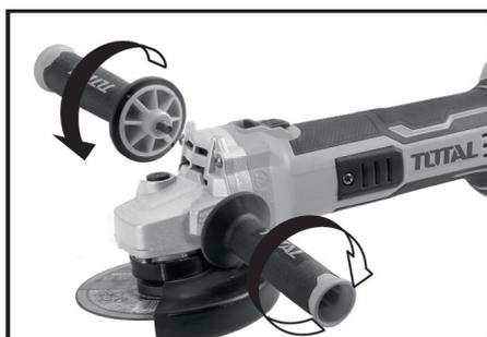
Atornille firmemente la empuñadura lateral en la posición de la herramienta como se muestra en la figura.
