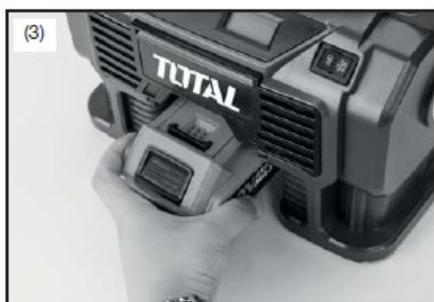
Far scorrere la batteria nella base dello strumento. (Si noti che la batteria ha delle nervature rialzate che le consentono di inserirsi nell'utensile in un solo modo.) Accertarsi che il pacco batteria scatti in posizione e che il pacco batteria sia fissato all'utensile prima di iniziare l'operazione, (Fig.3).
